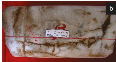
图 5-14 斜交缝，沥青半充填
