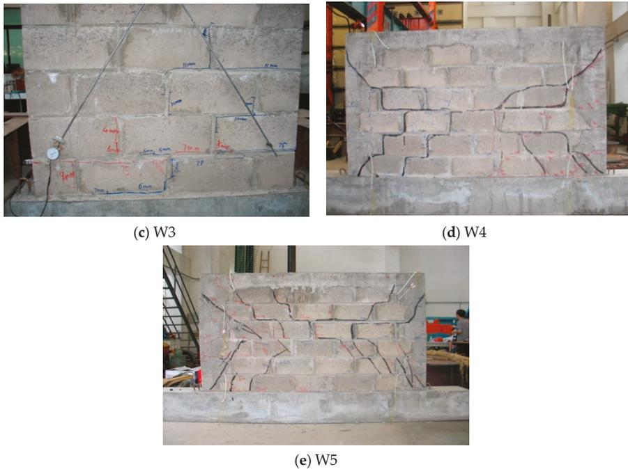
Figure 8. Failure mode of specimens: (a) W1; (b) W2; (c) W3; (d) W4; (e) W5.
