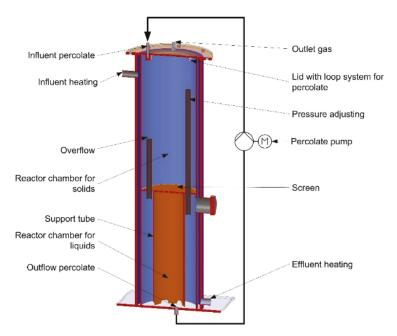
**Figure 2.** Schematic of percolate digester (dry digestion system) (Stur, Deutsches Biomasseforschungszentrum gGmbH (DBFZ)).
