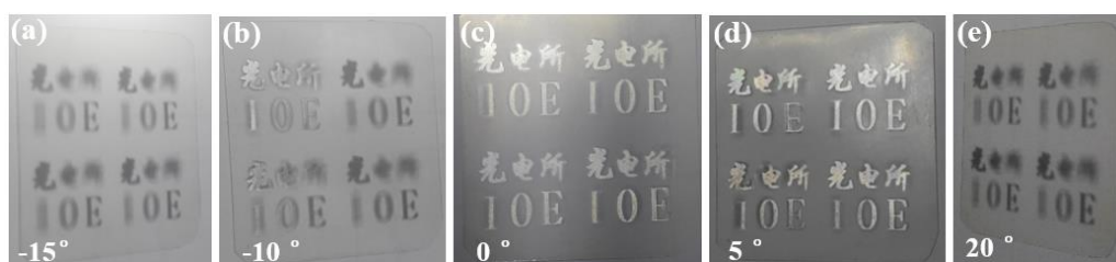
Figure 9. 3D effects from different viewing angles: (a) -15^\circ ; (b) -10^\circ ; (c) 0^\circ ; (d) 5^\circ ; (e) 20^\circ .
