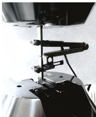
**Figure 8.** Mess & Feinwerktechnik GmbH MFA25 extensometer.
