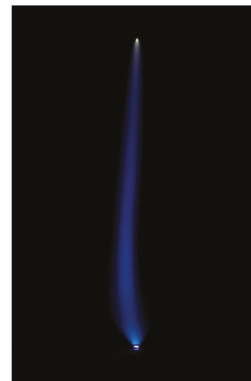
(d) Glow discharge U_{\text{supply}} = 10.6 \text{ kV} , i = 1.4 \text{ mA} (exposure 1/100 s)
