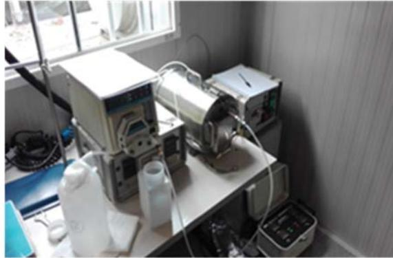
**Figure 2.** The butanol vaporisation system.
