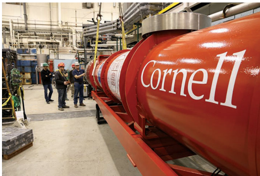
b) The main linac cryomodule.
