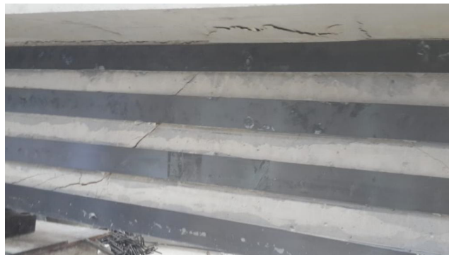
(d) Group 3 diagonal shear crack
