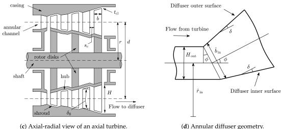
(d) Annular diffuser geometry.
