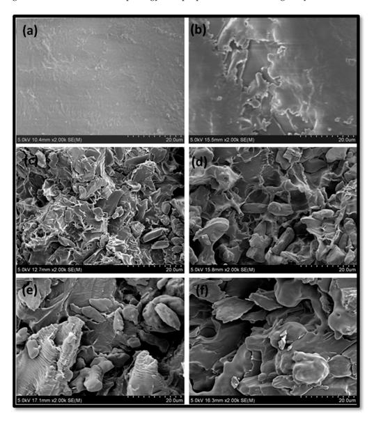
Figure 2. SEM images of (a) SMPU; (b) P1; (c) P2; (d) P3; (e) P4; and (f) P5.
